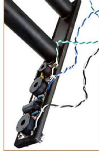
Die bestens bestückte Weiche sitzt direkt auf einem eigens für Vienna gefertigten Terminal.
